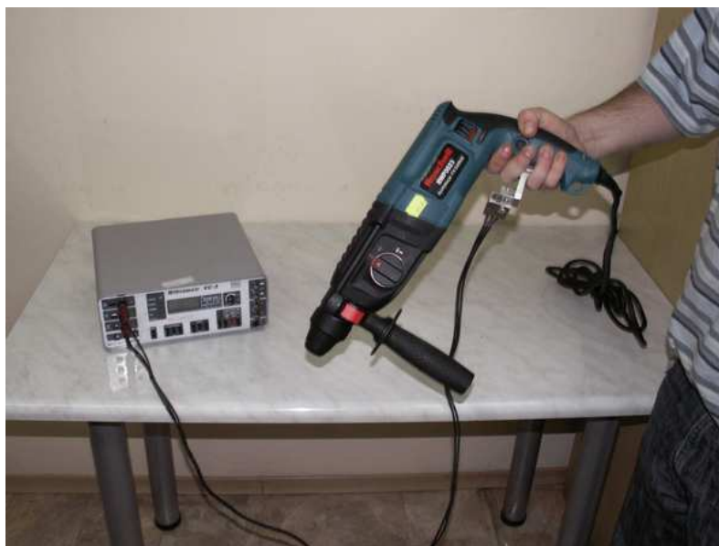
Rys. 4. Pomiar drgań przenoszonych przez kończyny górne [opracowanie własne]
