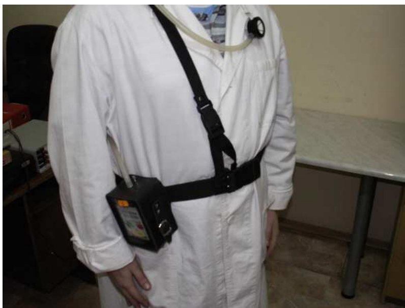
Rys. 7. Zestaw aparatury do pomiaru zapylenia w trakcie pomiaru [opracowanie własne]
