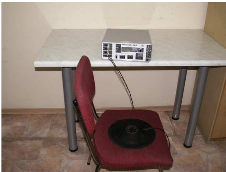
Rys. 5. Pomiar drgań o oddziaływaniu ogólnym, na siedzisku widoczny czujnik pomiarowy [opracowanie własne]
